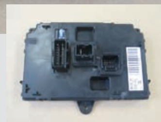
Moduly projektu pro Peugeot 407. Zadní elektronická řídicí jednotka je umístěna pod karosérií v zadní části vozu.
