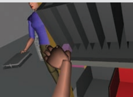
Model simulace člověka – uchopení součástky (pohled z perspektivy pracovníka)
